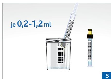
**Gewinnung der A + B Probe** durch Aufziehen in die Monovetten: **mind. 0,2 ml bis max. 1,2 ml je Monovette**.
